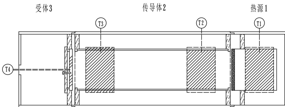
热源具有一个测温热电偶, 传导腔体有两个热电偶, 受体有一个热电偶, 它们都可以通过仪表显示。
